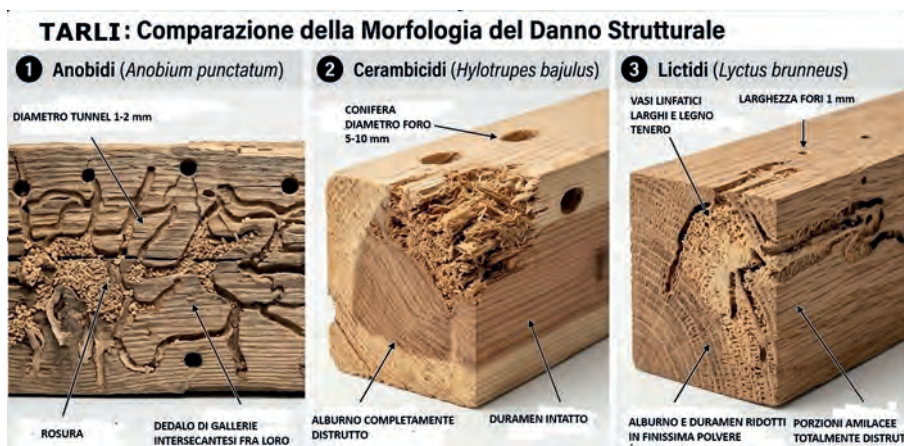
Figura 1: Fori di sfarfallamento e danni dei tarli.
